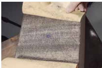
No migración lateral de agua mediante el ensayo ASTM D 5385
